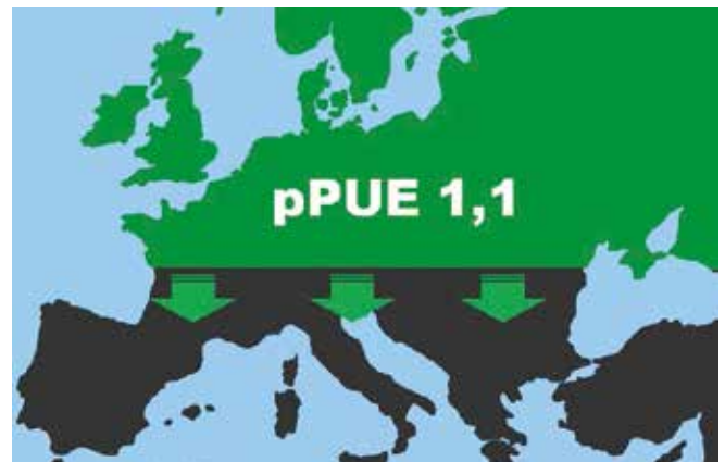
Figure 2. Le refroidissement adiabatique permet d'atteindre des valeurs de pPUE aussi basses que 1,1, même dans les pays du sud de la région EMEA.
