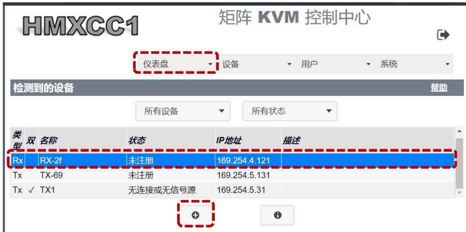
图6-15 到仪表盘>检测到的设备，选择任一未注册的设备，按下<注册>按钮
