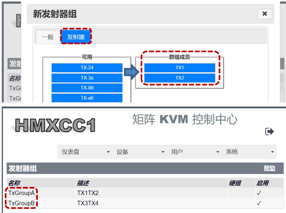
图6-20 已新增发射器组 TxGroupA/TxGroupB
