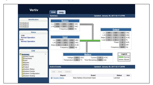
Figure 6.1 Vertiv<sup>™</sup> Liebert<sup>®</sup> IntelliSlot<sup>™</sup> Web Card Display
